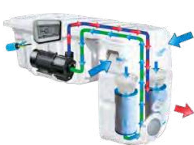
Schéma hydraulique du bloc filtrant (standard hors options)
